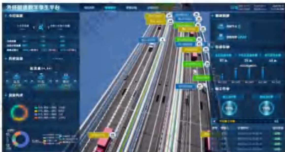
图 3.2-21 雷视设备采集通行车辆信息
