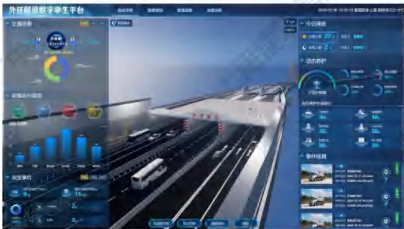
图 3.1-30 外环隧道结构健康孪生体
