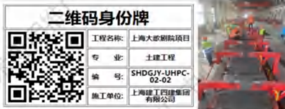
图 3.3-7 UHPC 梁二维码身份牌
