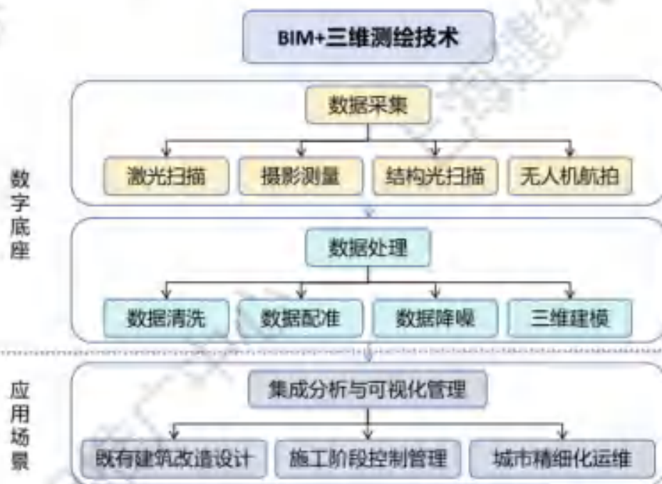
图 3.2-28 BIM+三维测绘实施技术路线
